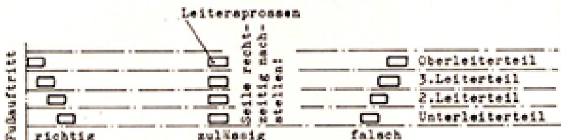
Bei der Nachstellung der Seile wird der Leiterpark so ausgezogen, daß die weiße Signalleuchte aufleuchtet. Beim zweiten Leiternteil beginnend wird dann die Seilnachstellung für die Leiterteile 3 und 4 für den 4-teiligen Leitersatz, durchgeführt. Schlappseilbildungen sind zwar durch die gewählte Seilführung weitgehend ausgeschaltet, doch ist eine Überwachung unerlässlich, da Schlappseile den Leiternbetrieb gefährden. Seile dürfen nur auf Zug nicht aber auf Scherung beansprucht werden.
